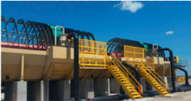
Sonderausführung, Typ ESZF... mit Feinsandrückgewinnung
